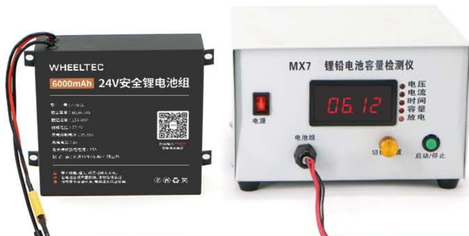
24V 6000mAh磷酸铁锂电池实测 6120 mAh
